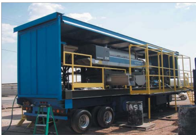
Рис. 1. Комплексная мобильная установка по переработке нефтешлама
